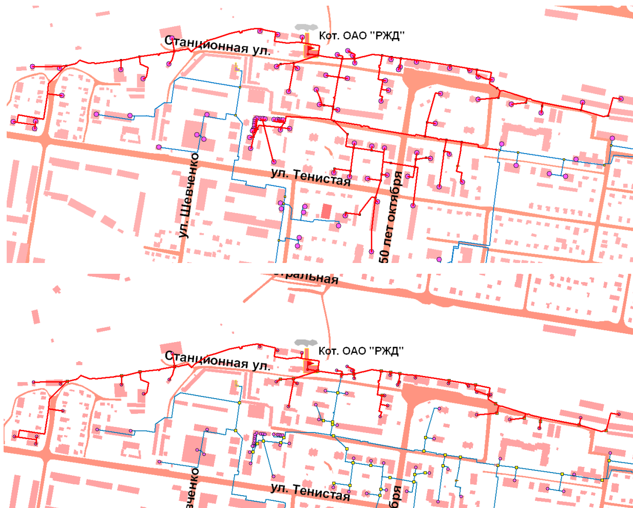
Рисунок 5.1.9. Схема переключения на БТЭЦ потребителей котельной ОАО «РЖД»
